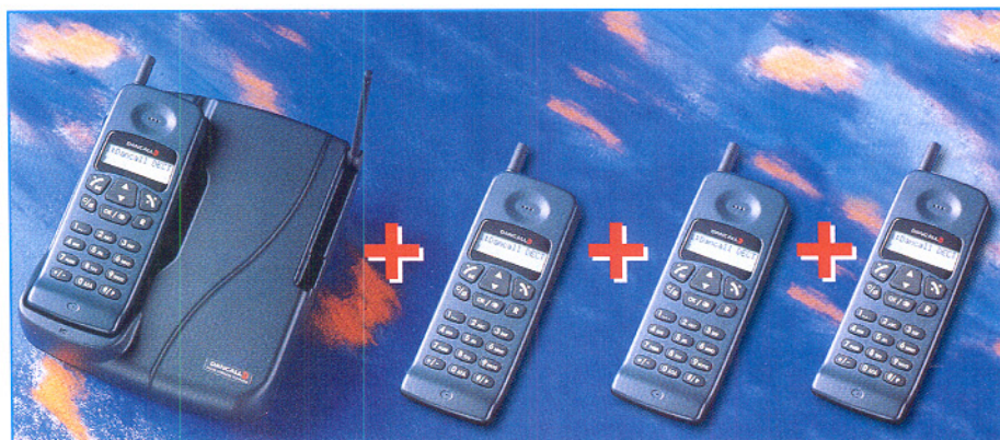
Bild 3: Eine DECT-Basisstation kann mehrere Mobilteile bedienen. Im Bild das Dancall-DECT-System 8X00, das bis zu 6 Mobilteile und zwei Amtsleitungen verwaltet und mit einem Repeater auch größere Gelände abdeckt.
