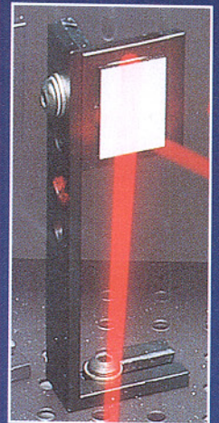
Bild 4: Spiegelhalter mit angeschraubtem Halte Winkel und aufgeklebtem Oberflächenspiegel
