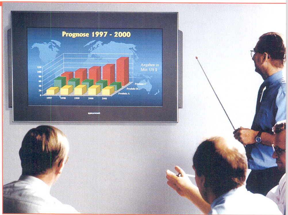
Bild 26: Durch die VGA-Schnittstelle sind die Plasma-Flachbildschirme auch als überdimensionales Computerdisplay, z. B. für Schulungen und Präsentationen, aber auch für das PC-Spiel zu Hause einsetzbar.
