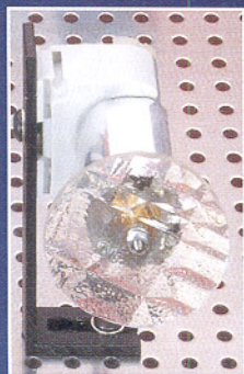
Bild 11: Getriebemotor zur Aufnahme von Gittereffekten oder Kathedralglasfolien (Schlierenmuster)
