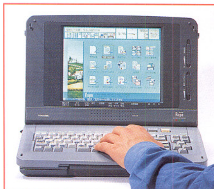
Bild 19: LC-Farbbildschirme finden heute schon massenhaft im Computerbereich Anwendung. Hier ein 10,4"-Display in einem Notebook. Foto: Optrex
